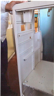
大型テーブルスポットで製作するセルフレジパネル
