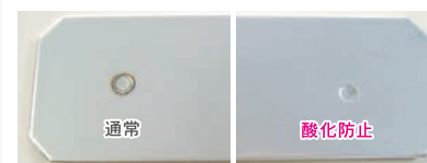
通常 酸化防止 ステンレスの焼け取りの工程が削減できます。
