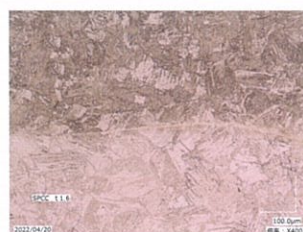
断面マクロ試験 (一部拡大) (鉄ビス・M6×SPCC t1.6)
