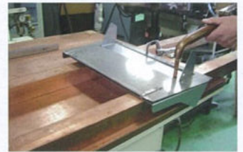
銅ブロックを置いて高さを作り、 凸部分を逃がせば、スポットできる
