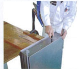
長い銅ブロックを置いてワークを 掛ければスポットできる
