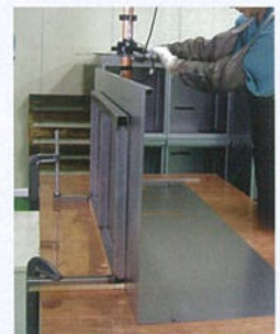
衝立のようなジグを作り、万力で固定。 ワークを沿わせれば一人で楽にスポットできる。
