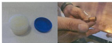
導電グリスをテーパ部分に塗布して暫定処置
